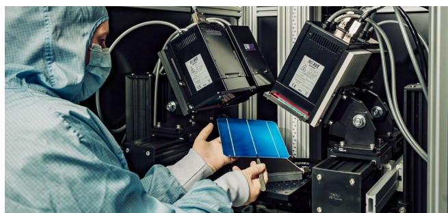
Banc optique qui permet de caractériser des cellules photovoltaïques à l'Institut photovoltaïque d'Île-de-France (IPVF Chimie ParisTech-PSL/CNRS/École polytechnique/IPVF). © Cyril FRESILLON/IPVF/CNRS Images
