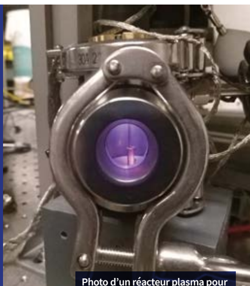
Photo d'un réacteur plasma pour la production d'hydrogène.
